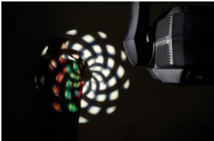
**Gobo 2** ist ein rotierender „Fan“, dem ein statisches Fan-Gobo hinterlegt ist, der rotierende Fan ist hier scharf
