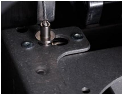
**Schnappverschluss** für die Sicherung der Kopfabdeckung – besser kann man es nicht lösen
