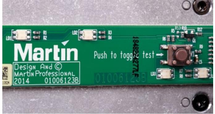
**Ideal für den Service** Aktivieren eines Testdurchlaufs direkt im Kopf
