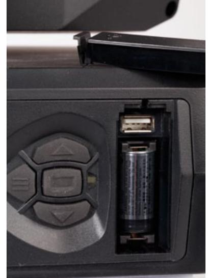
**Von außen zugängliche Abdeckung** für den Pufferakku des Displays sowie USB-Anschluss für Updates
