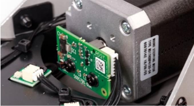
**Pan und Tilt** Zur Positionskorrektur werden auf der rückseitigen Welle Impulse aufgenommen
