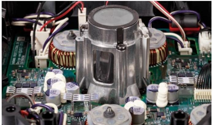
**Träger des Lichtleitsystems** mit einer Öffnung zur Zwangskühlung der gummiartigen Lichtleitplastik, rückseitig sorgen zwei gefilterte Luftdurchlässe für den Luftstrom
