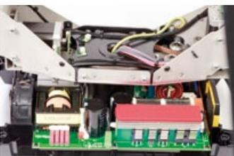
**Bei Martin selbst entwickelte Netzteile** mit durchdachter Zwangslüftung von rechts nach links
