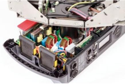
**Luftfilter, die zur Wartung gereinigt werden** sind deutlich gelb eingerahmt
