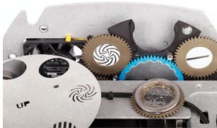
**Mit drei Schrauben** wird die statische Goboplatte auf das rotierende Gobarad geschraubt
