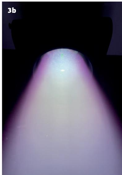
**Die Homogenität der Farbmischung** ist im Bereich leicht gesättigter Farben und Pastelltöne nicht vollumfänglich zufriedenstellend. Vor allem der Farbdichteverlauf auf den CMY-Flags (Abb. 3a) ist nicht linear genug, was zu einer Farbkorona im Beam führen kann (Abb. 3b)
