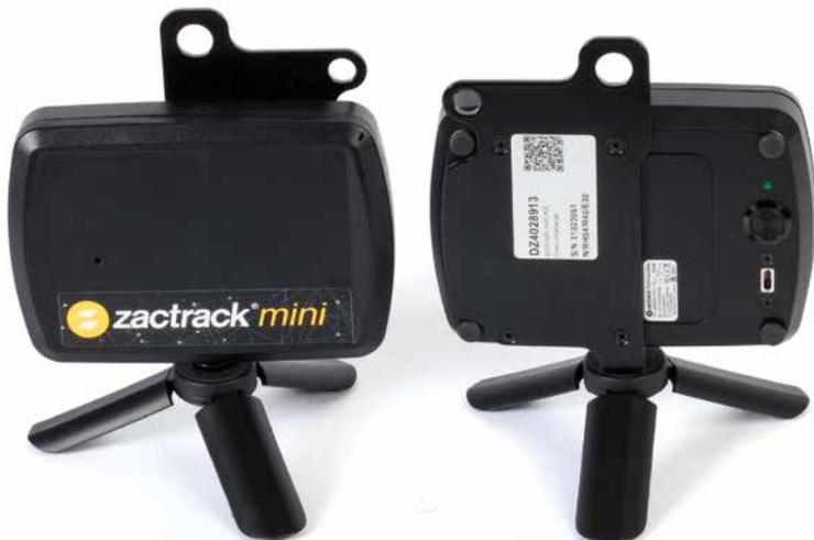
**Empfänger** mit Rechner, der die Kommunikation zum Server selbstständig aufbaut und die Laufzeiten zum Sender (Tracker) ermittelt
