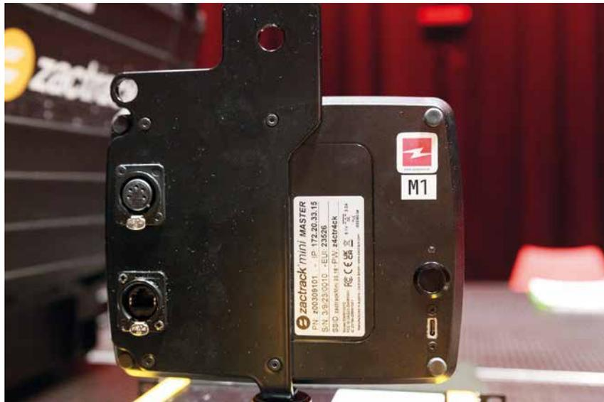
**Rückseite des Servers (Master-Anchor)** mit 5pol. DMX-Ausgang und RJ45-Netzwerkanschluss
