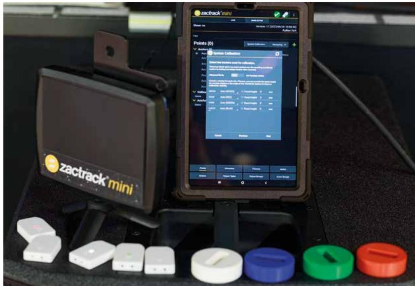
**LED-Farben** identifizieren die Tracker; zur Positionierung und Kennzeichnung auf dem Boden werden farbige Halteschalen aus dem 3D-Drucker mitgeliefert
