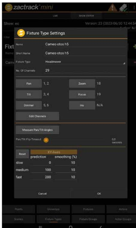
**Erstellung eines eignen Fixtures** für Zactrack ist sehr einfach, da man neben der Gesamt-Steuerkreisanzahl nur die Kreise für Pan/Tilt, Zoom/Fokus, Dimmer und Iris angeben muss
