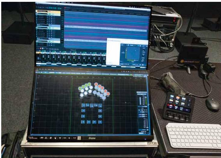
**En-Scene** Der obere Bildschirm zeigt die Spuren der Tonquellen, während im unteren Bildschirm die Positionierung der Tonquellen angezeigt. Dort kann man auch jederzeit die Positionierung einer Klangquelle ändern, was man real auch sehr gut hören kann. Im Hintergrund rechts neben dem Display das Verstärkerrack für die verwendeten Lautsprecher. Zum Umschalten der Raumsimulation diente bei unserem Test ein Elgato Stream Deck
