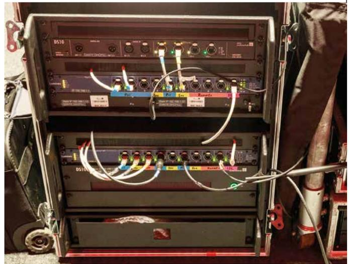
**Demorack mit DS100** sowie zwei Luminex-Switches und einem DS10 (Schnittstelle zwischen dem Dante-Netzwerk und digitalen AES3-Audiosignalen) sowie hinter der Blende zwei Apple-Mini-PCs
