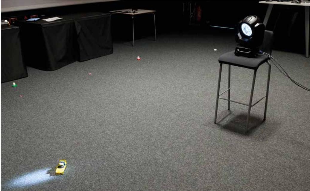
**Endlosverfolgung eines RC-Fahrzeuges** um einen zentriert positionierten Movinghead
